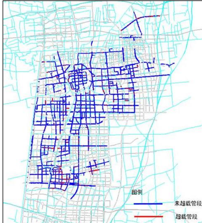
图 2-1 海陵区雨水管道评估 (p=1 年设计雨型)
