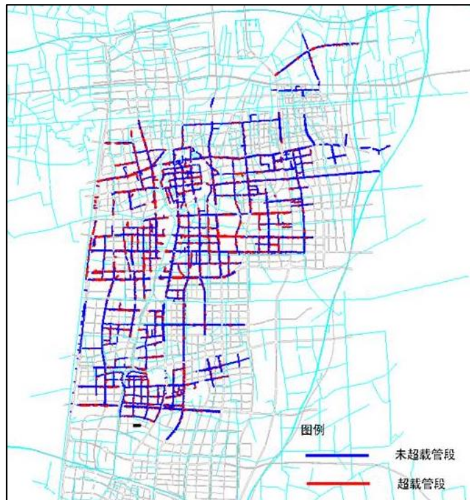
图 2-2 海陵区雨水管道评估 (p=3 年设计雨型)
