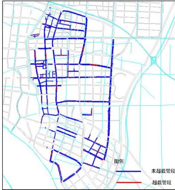
图 2-3 高港区雨水管道评估 (p=1 年设计雨型)
